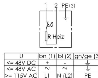
(1) Sonderspannungen z.B.: 12V AC/DC, 24V AC/DC, 48V AC/DC, 115V AC, 400V AC auf Anfrage möglich
