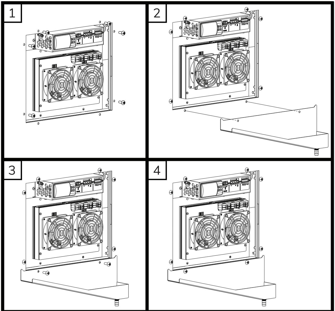
1. Montieren Sie das thermoelektrische Kühlgerät am Schaltschrank, wie im Handbuch beschrieben, ohne jedoch die unteren Schrauben zu befestigen. Diese werden zur Befestigung der Kondensatwanne benötigt.
